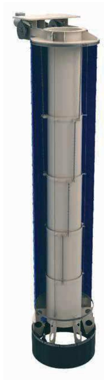
Die robuste Verladegarnitur vom Typ NZO600H mit Staubglocke und zwei Füllstandsmelder, stellt eine staublose Verladung von trockenem Schüttgütern auf LKW und offene Waggons sicher.
